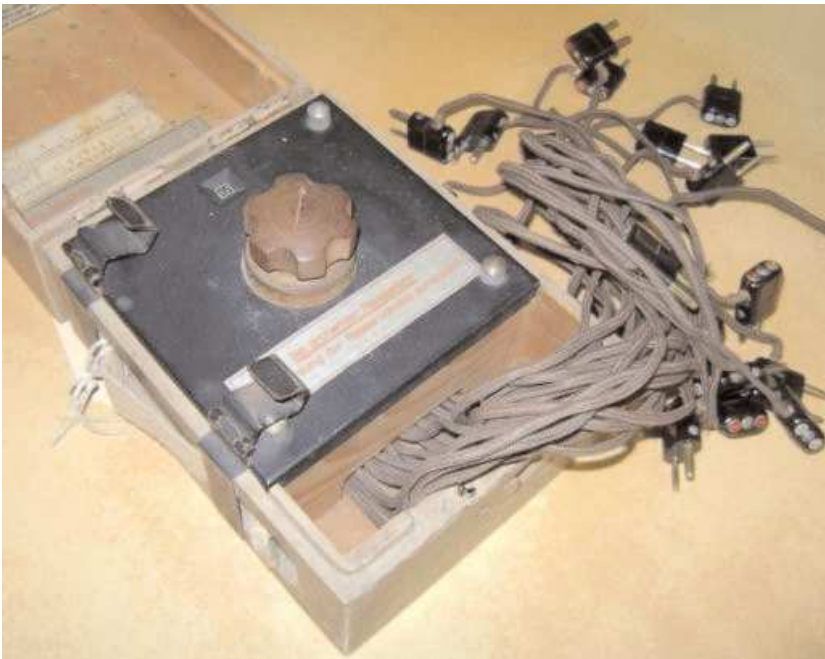
L'Uhr ed i suoi cavi che sostituiscono i cavi standard.
