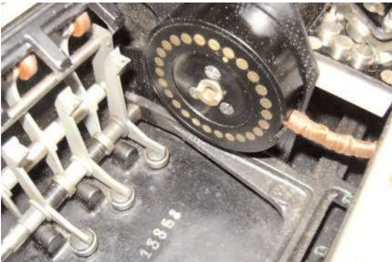
I tre nottolini sul loro asse, a riposo sui piedini. L'asse dei nottolini è fissato sulla barra di avanzamento (la forma ad L di color argento). Alla destra dei nottolini si può vedere lo statore.
