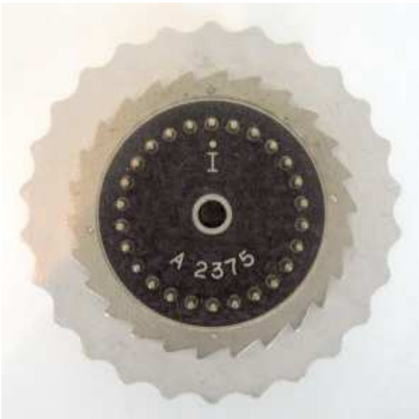
Lato destro di un rotore con la sua ruota a denti di sega
