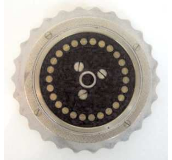
Veduta da sinistra di un rotore con la sua tacca (a sinistra)
