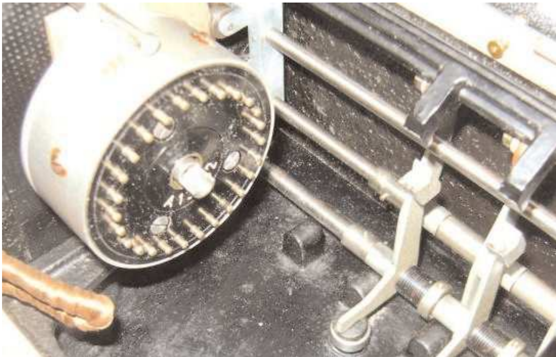
Il riflettore B dell'Enigma della Wehrmacht
